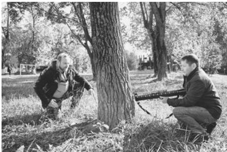
Выявление скрытых дефектов растущих деревьев при помощи прибора Resistograph
